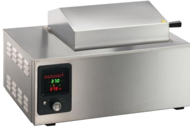
عبارة عن حوض من المعدن مستطيل الشكل له غطاء يوجد بقاعه سخان لرفع درجة حرارة الماء حتى الغليان ويستخدم في حالات التسخين غير المباشر بواسطة الماء أو البخار لبعض المحاليل وصهر بعض المواد المستخدمة في المختبر مثل الشمع أو الدهون. ويوجد به منظم حرارة thermostat للتحكم في درجة حرارة الحمام المائي عند حد معين . كما أنه يمكن أن يستخدم في عمليات التعقيم بالغلي لبعض الأدوات.
