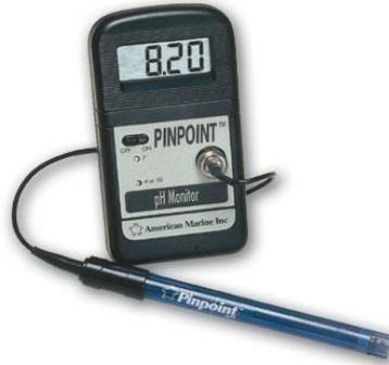
جهاز الكتروني يستخدم لقياس الاس الهيدروجيني للمحاليل المختلفة وغالبا ما تتراوح النتائج بين الحامضى > 7 وقاعدى < 7 اما نقطة التعادل فهي غالبا تعابير مع الماء المقطر = 7 ومن الممكن التعرف على نوع المحلول بواسطه شرائط جافة لورق عباد الشمس كالاتى :-
